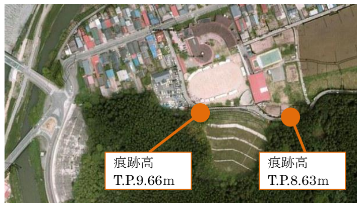
大川小学校周辺の津波痕跡高 (専門家提供資料をもとに作図したため測量箇所は概ねの位置。)
