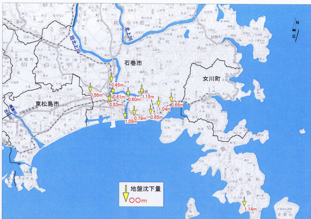
図 2-12 市内の地盤沈下状況
