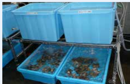
▲マイクロ・ナノバブルを用いたマガキの細菌・ウイルス除去(浄化)試験
