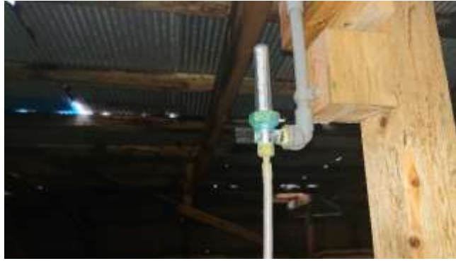
【液体酸素注入装置】液体に直接酸素を送り込むことで、赤潮発生時の海水揚水が困難な場合での養殖継続が可能となる。
