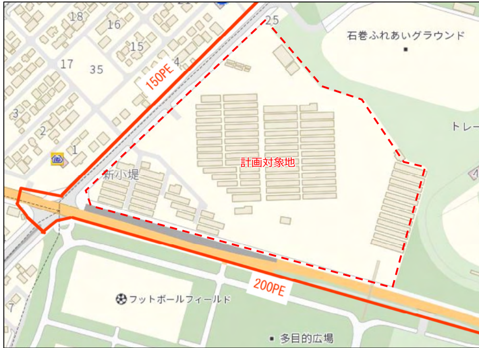
図 22 埋設ガス配管図
