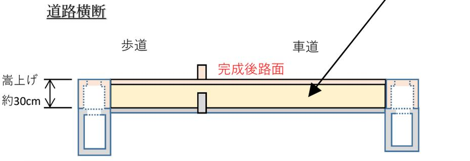
路面を約30cm嵩上げします。これにより三陸道下の車両制限高さが4.0m以下となり、入口に制限表示板を設置します。
