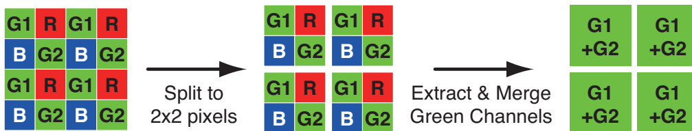
図 2.9 raw2fits によるベイヤー配列の分解
