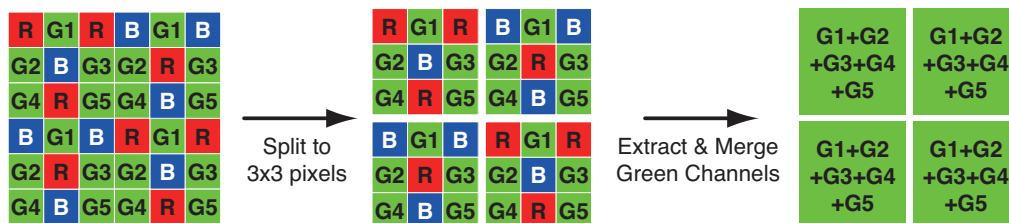
図 2.10 raw2fits による X-Trans 配列の分解
