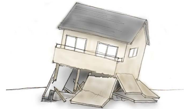
（基礎及び1階部分が崩れた住宅）
