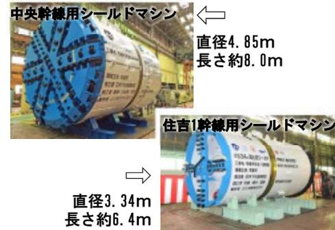
石巻中央幹線や住吉1号、2号幹線はシールドマシンを用いて地下を掘進め雨水が流れる管を作っていきます。
