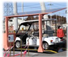
グリーンスローモビリティ及び太陽光電池搭載の非接触給電ステーション
