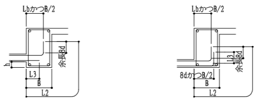
図10-3-1 スラブが梁側面に付く場合
