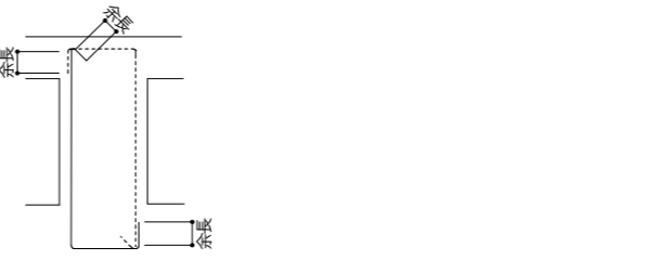
図2-3-6 副あばら筋・副帯筋の形状
