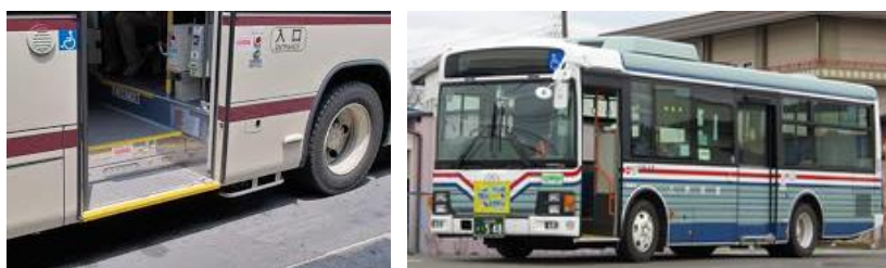
図 低床バス（左：ワンステップバス、右：ノンステップバス）
